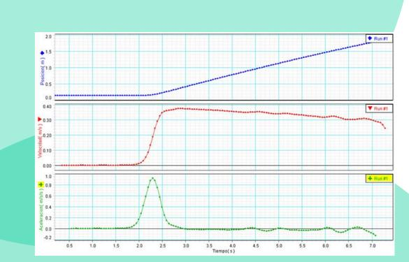
Estudio del movimiento de un planeador sobre una pista de aire, recta y horizontal, utilizando un sensor de movimiento. Las consignas posibilitan:
