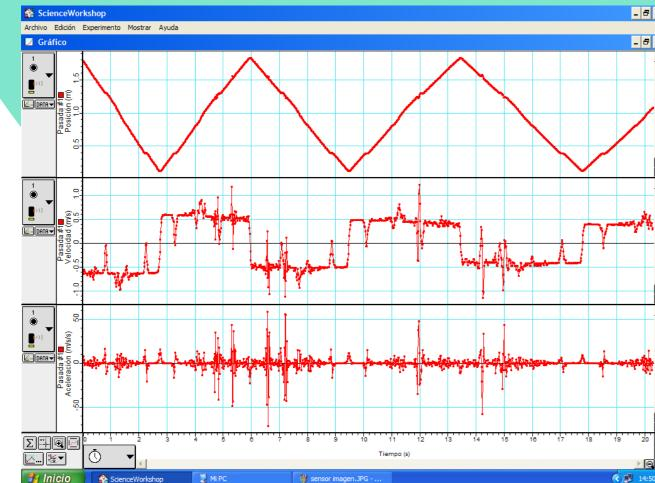
Estudio del movimiento de un planeador en sucesivas idas y vueltas sobre una pista de aire, recta y horizontal, utilizando un sensor de movimiento.
