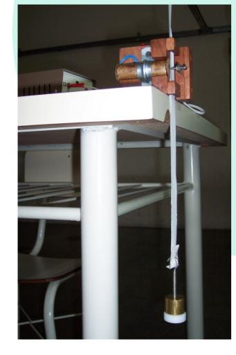
Análisis del movimiento de un cuerpo que cae verticalmente utilizando un registrador de movimiento. Las consignas orientan:
